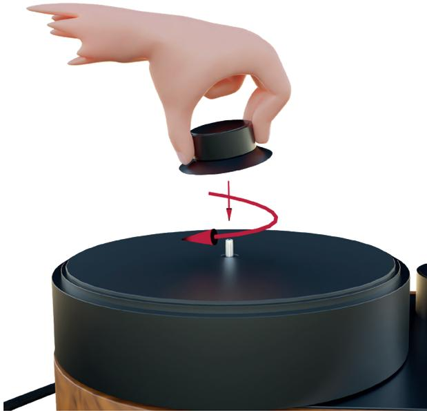
DE: Um die Reflexklemme zu verwenden, legen Sie eine Schallplatte auf den Plattenteller und drehen die Klemme (im Uhrzeigersinn) auf die Spindel.
