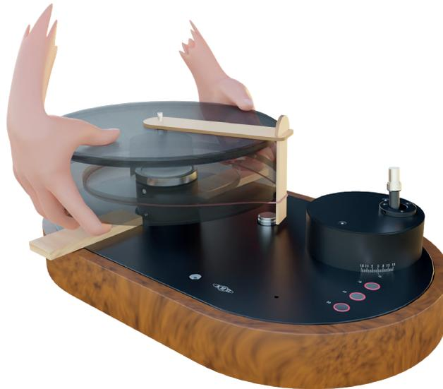
DE: Setzen Sie den Plattenteller so auf die Unterlegklötze, dass sich die Antriebscheibe des Motors innerhalb des Riemens befindet. Nun können Sie die Position des Riemens kontrollieren. Anschließend lassen Sie die Holzklötze von einer zweiten Person entfernen, während Sie den Teller nochmal leicht anheben. Setzen sie nun den Teller langsam auf den Subteller ab. Jetzt können Sie die Einfädelhilfe nach oben abziehen und der Riemen schnappt in die Antriebscheibe.
